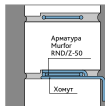
Пониженный шов с арматурой и хомутами 8 - 9 мм
